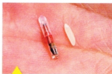
Les puces RFID utilisées dans les clés de démarrage sans contact sont très petites mais pas si sécurisées que cela...
