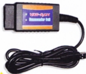
Une prise OBD-II vers USB. Avec ce type d'adaptateur et le logiciel CarShack, il est possible de contrôler différents points d'une voiture. Ça n'arriverait pas sur ma 4L...
